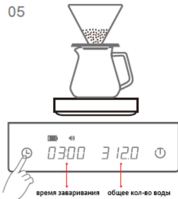
По завершении заваривания нажмите кратковременно для остановки таймера. На панели отобразится точное время заваривания.
