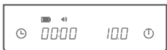
Включите весы и поставьте заварочную емкость на весы. Разместите бумажный фильтр и нажмите на кнопку затаривания – взвешивания тары. Подождите пока не о тобразится 0, затем можно наполнять ёмкость или засыпать кофе в пуревер.
